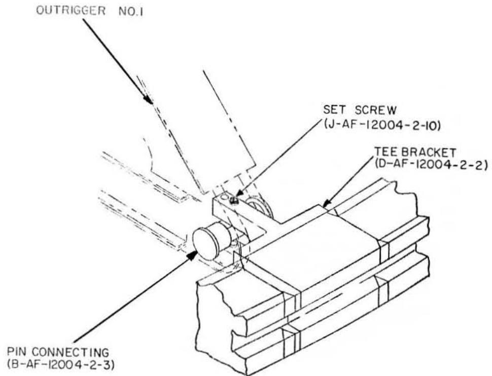
FIG.14. BOOSTER STABILIZATION PREPARATORY TO LIFTING OFF TRANSPORTER
